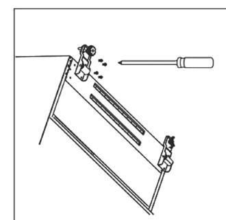
6. A készülék telepítése után a fenti lépéseket fordított sorrendben megismételve szerelje vissza a készülékre az ajtókat.
