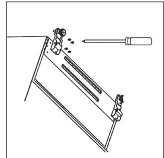
6. Po wypoziomowaniu urządzenia przykręcić drzwi, postępując w odwrotnej kolejności w stosunku do kroków podanych wyżej.
