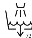
Každý tretí deň vyprázdnite a znova naplňte nádržku. Pred naplnením ju vyčistite vodou z vodovodu alebo čistiacimi prostriedkami, ak ich požaduje výrobca. Odstráňte prípadný vodný kameň, usadeniny alebo povlak, ktorý sa vytvoril na stenách nádržky alebo na vnútorných povrchoch a všetky povrhy do sucha utrite.
