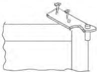
Ota vasen yläsarana laitteeen mukana toimitettavasta välipakkauksesta ja aseta se paikalleen.
