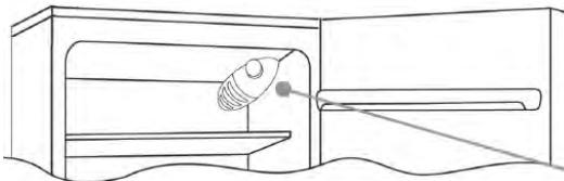
A caja do termostato que controla o equipamento está localizada dentro do compartimento do frigorífico no lado superior direito. Para verificar se o equipamento está a funcionar, certifique-se de que o botão do termostato não está para "0".
