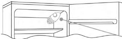
De thermostaat van het apparaat bevindt zich rechtsboven in het koelgedeelte. U kunt alleen controleren of het apparaat werkt als de thermostaatknop niet op 0 staat.
