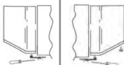
Fjern hettene (A) og (B), skru av skruene og trekk dekselet delvis av.
