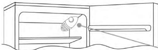
Termostat určeny k ovládání spotřebiče je umístěny uvnitř chladničky vpravo nahore. Pokud chcete zkontrolovat, že zařízení opravdu funguje, přesvědčete se, že termostat není nastavený v poloze „0“.
