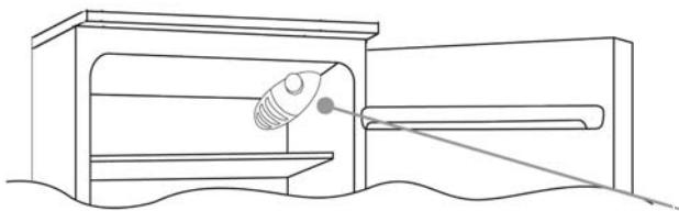
Laitteen säätöön tarkoitettu termostaattilaatikko sijaitsee jäätäkappiosaston sisällä oikealla ylhäällä. Kun haluat tarkastaa, että laite toimii, varmista, että termostaattinuppi ei ole asennossa "0".
