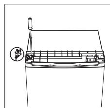
12. Nasadte horní kryt a upevněte jej pomocí 2 šroubů na zadní straně.
