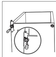
11. Helyezze vissza az ajtót! Mielőtt teljesen rögzíti a csavarokat, ellenőrizze az ajtó függőleges és vízszintes oldalát és a tömítés megfelelő működését!
