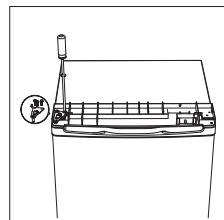
12. Nasadte horný kryt a upevnite ho pomocou 2 skrutiek na zadnej strane.
