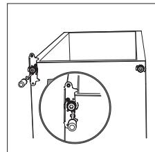
11. Vráťte dvere späť. Než definitívne dotiahnete skrutky, skontrolujte, či dvere horizontálne aj vertikálne doliehajú a či tesnenie po všetkých stranach správne dosadá.
