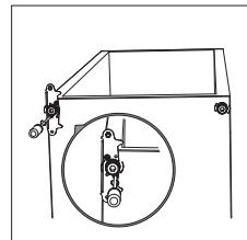
11. Vraťte dveře zpět. Než definitivně dotáhnete šrouby, zkontrolujte, zda dveře horizontálně i vertikálně lícují a zda těsnění po všech stranách správně dosedá.
