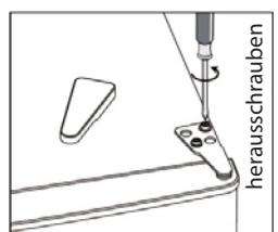
3. Entfernen Sie die Abdeckung der linken Schraube.
