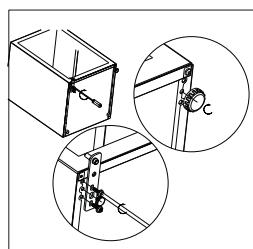
7. Załącz drzwi. Upewnij się, czy są poziomo i pionowo wyrównane a uszczelka przylega do nich ze wszystkich stron. Później dokręć śrubki górnego zawiasu.
