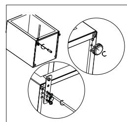
7. Nasadte dvírka. Ujistěte se, že jsou vodorovně i svisle vyrovnána a těsnění k nim přiléhá na všech stranách. Teprve poté dotáhněte šrouby horního závěsu.
