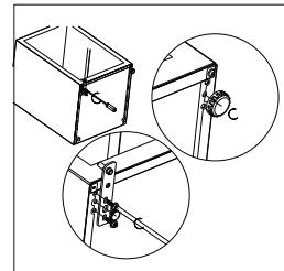
7. Setzen Sie die Tür ein. Vergewissern Sie sich, dass sie waagerecht sowie senkrecht ausbalanciert ist. Die Dichtung muss auf allen Seiten gut sitzen. Erst dann ziehen Sie die Schrauben des Oberscharniers fest.
