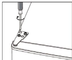
10. Installieren Sie die Abdeckung des Scharniers und der Schraube.
