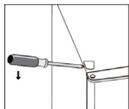
4. Verschieben Sie die Abdeckung der Schraube von links nach rechts.
