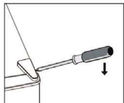
2. Entfernen Sie die Schrauben und das Oberscharnier.
