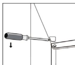
4. Pokrov vijaka dajte z leve na desno stran. Nato dvignite vrata in jih postavite na oblazinjeno površino, da se ne poškodujejo.
