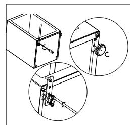
7. Szerelje vissza az ajtót. Ügyeljen, hogy vízszintesen és függőlegesen megfelelő helyzetben legyen és hogy a tömítés minden oldalról szorosan az ajtóhoz simuljon. Csak ezután szabad behúzni a felső zsanér csavarjait.
