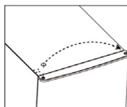
5. Odvijte in odstranite zatič spodnjega tečaja, obrnite nosilec in ga prestavite.
