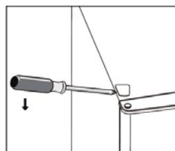
4. Przesuń pokrywę śrubki z lewej strony na prawą. Podnieś drzwi i umieść je na tapicerowanej powierzchni, by się nie porysowały.
