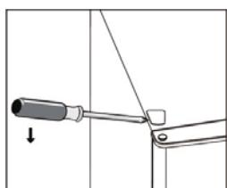
4. Presuňte kryt skrutky zľava napravo. Potom zdvihnite dverka a umiestnite ich na čalúnený povrch, aby sa nepoškrabali.
