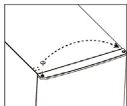
5. Schrauben Sie den Zapfen des Unterscharniers heraus, entfernen Sie ihn, drehen Sie den Halter und versetzen Sie ihn.
