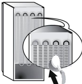
Pravidelně čistěte přiloženým nástrojem vnitřek odtokového otvoru, který je umístěný na zadní stěně spotřebiče u zásuvky na ovoce a zeleninu; zajistíte tak stálý a pravidelný odtok rozmrzené vody.
