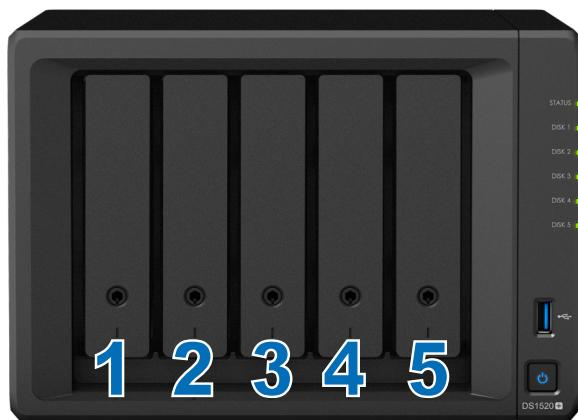
**Poznámka:** Pokud plánujete vytvořit svazek RAID, doporučujeme nainstalovat disky o stejné velikosti, aby byla kapacita disků využita co nejlépe.
