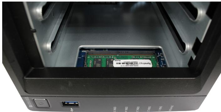
**Poznámka:** Vyjmutím přihrádek na disky odkryjete citlivé vnitřní součásti. Při odebírání nebo přidávání paměti se nedotýkejte ničeho jiného než paměťové sestavy.
