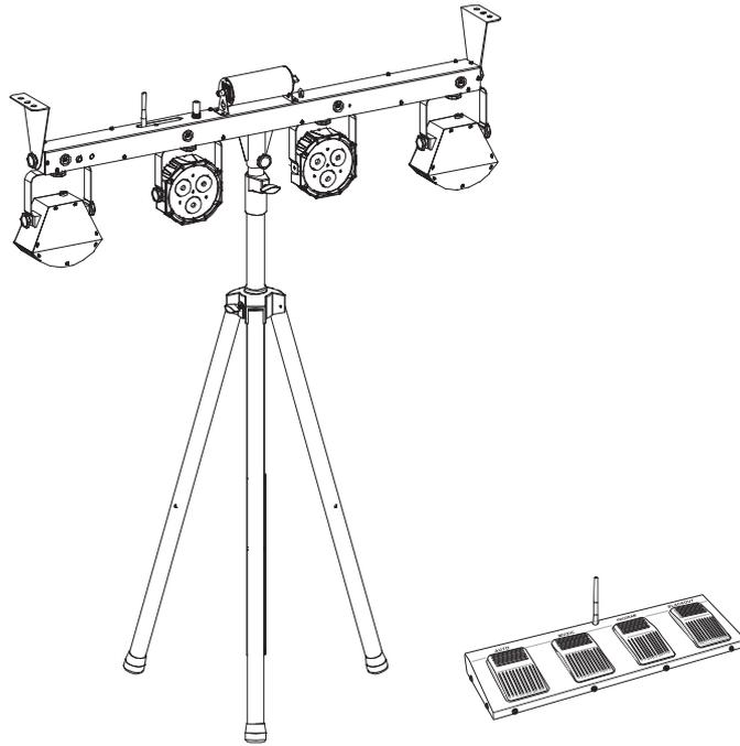
Für den mobilen Einsatz setzen Sie das Lichtset über die Stativhülse auf ein Leuchten-Stativ auf und fixieren es mit der Feststellschraube. Passende Stative finden Sie im Kapitel Zubehör.
