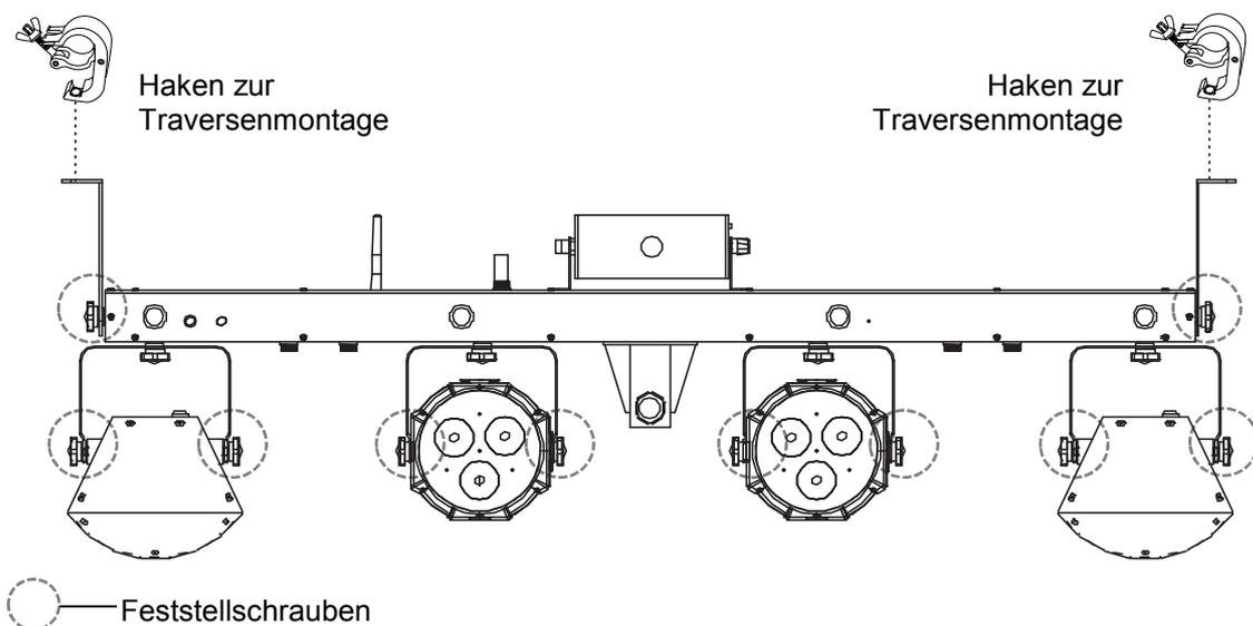
Das Gerät ist zur Überkopfmontage über die Montagebügel vorgesehen. Montieren Sie es über die Bügel an einer Wand oder einer Decke. Alternativ kann es auch mit geeigneten Haken über die Bügel an einer Traverse befestigt werden.
