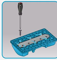
**FR** Retirer la lingette. Vider le réservoir d'eau. Enlever les 8 vis du système de distribution d'eau, remplacer le ressort et le système de distribution d'eau, revisser le système de distribution d'eau au réservoir.
