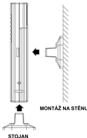
Připevněte držák k dolní části venkovního vysílače pro postavení na stůl nebo jej připevněte k zadní části vysílače pro montáž na stěnu.
