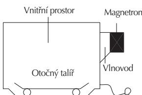
U mikrovlnné trouby je elektrina měněna na mikrovlny magnetronem.
