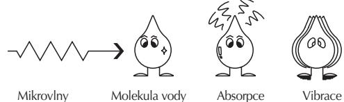
Mikrovlny způsobují vibraci molekul vody, čímž vzniká teplo. Toto teplo následně ohřívá potraviny. Mikrovlny se rovněž vážou na molekuly tuku a cukru, proto jídlo s vysokým obsahem tuku nebo cukru se ohřívá rychleji. Mikrovlny mohou pronikat do hloubky 4 - 5 cm, a proto se teplo šíří v potravinách pomocí vedení, podobně jako u tradičních trub, je jídlo ohříváno od okraje ke středu.
