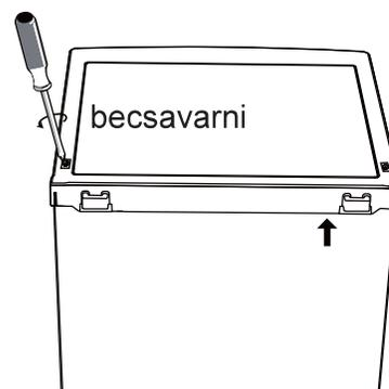
10. Mielőtt teljesen rögzíti a csavarokat, ellenőrizze az ajtó függőleges és vízszintes elhelyezését és a tömítés megfelelő funkcióját!
