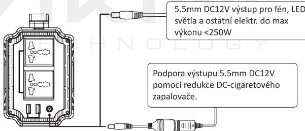
**Poznámka:** Výstupní napětí DC 12V, je v rozmezí 9V až 12,6V, maximální výstupní proud je 6A. Při poklesu výstupního napětí DC, klesá i kapacita baterie kvůli chemickému vlastnostem baterie. Není-li ve vašem přístroji zabudovaná funkce stabilizace vstupního napětí, může se napájené zařízení vypnout, pokud je vstupní napětí příliš nízké. Odpojte přístroj od bateriového generátoru a generátor včas dobijte.
