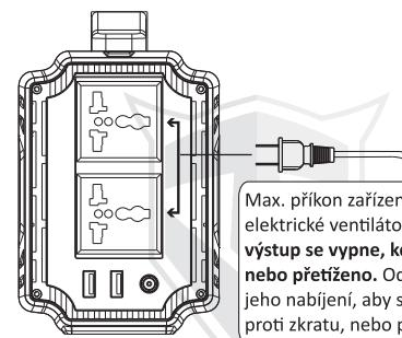
Max. příkon zařízení <250W, ideální pro lampy, elektrické ventilátory, televizory atd. **AC výstup se vypne, když je zařízení zkratováno nebo přetíženo.** Odpojte bat. gen. a spusťte jeho nabíjení, aby se restartovala ochrana proti zkratu, nebo přetížení.
