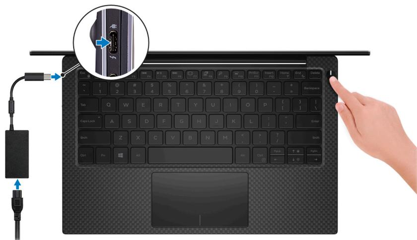
**POZNÁMKA:** Kvůli úspoře energie může baterie přejít do úsporného režimu. Připojte napájecí adaptér a stisknutím tlačítka napájení počítač zapnete.
