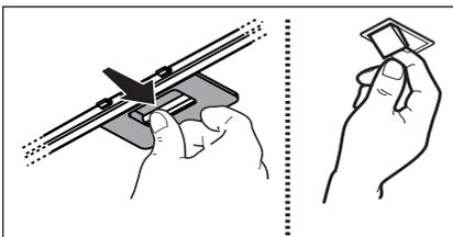
**4.2 Der NICHT waschbare Aktivkohlefilter** - Je nach der Benetzungsdauer des Herdes und der Häufigkeit der Reinigung des Fettfilters tritt nach einer mehr oder weniger langen Benetzungsdauer die Sättigung des **Aktivkohlefilters** auf. Auf jeden Fall muß der Filtereinsatz mindestens alle 4 Monate ausgewechselt werden. Er kann NICHT gereinigt oder erneut aktiviert werden.
