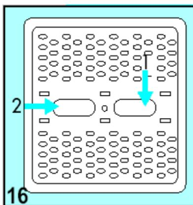
Чтобы вынуть предметы, случайно провалившиеся между барабаном и внешним корпусом машины, следует снять пластмассовую крышку противовеса, находящего в барабане с противоположной отверстию стороны (рис. 16), затем открыть створки и достать со дна предметы.
