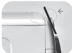
**Pokud neznáte pozici NFC antény, krouživými pohyby lehce pohybujte chytrým telefonem nad logem Smart Touch dokud aplikace nepotvrdí připojení. Aby byl přenos dat úspěšný, je nutné UDRŽOVAT CHYTRÝ TELEFON V BLÍZKOSTI OVLÁDACÍHO PANELU BĚHEM CELÉHO NĚKOLIKAVTEŘINOVÉHO PŘIPOJENÍ. Následně Vás bude zařízení informovat o správném výsledku operace a oznámí Vám, že je možné přesunout se s chytrým telefonem kamkoliv.**
