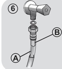
● **AQUAPROTECT - PRÍVODNÁ HADICA S OCHRANOU (obr. 6):** Ak voda preteče z hlavnej internej hadice "A", transparentný izolačný plášť "B" udrží vodu na dokončenie pracího cyklu. Na konci cyklu kontaktujte autorizované servisné stredisko pre výmenu prívodnej hadice.
