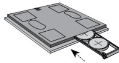
Po vložení baterii, držák zasuňte do přístroje.
