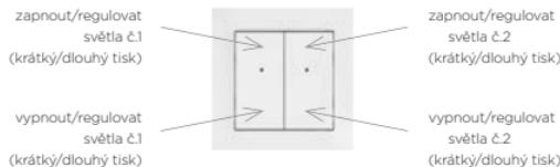
Nastavení nástěnných ovladačů lze měnit – viz. manuály jednotlivých prvků iNELS
