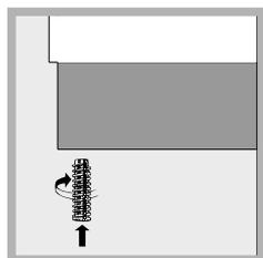
Se è necessario livellare l'apparecchio, avvitare i piedini di regolazione forniti in dotazione nelle apposite sedi poste negli angoli alla base della cucina (*vedi figura*).
