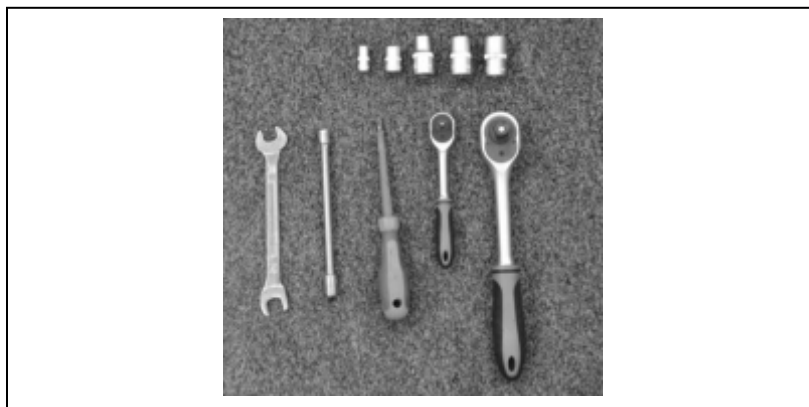
Momentový klíč s ráčnou, prodlužovací nástavec, nástavec č. 8, 10, 12, 14, 17
