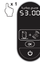
53-minutový cyklus 8 minut sterilizace + 45 minut sušení
