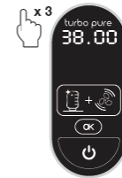
38-minutový cyklus 8 minut sterilizace + 30 minut sušení
