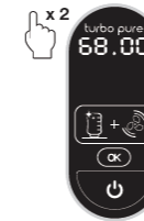
68-minutový cyklus 8 minut sterilizace + 60 minut sušení
