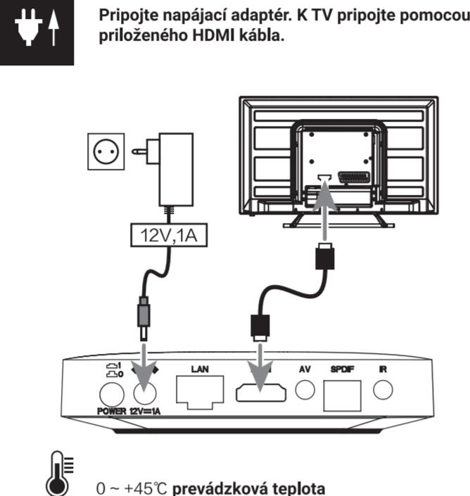
Pripojte box do siete buď pomocou LAN konektoru alebo cez WiFi pripojenie (802.11 b/g/n/ac; 2.4/5 GHz)
