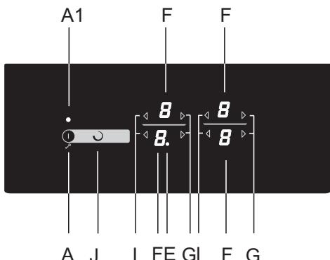
Po zapnutí varné desky (v následujících 10 sekundách) zapněte požadovanou varnou zónu.
