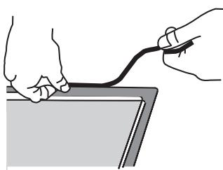
Nejprve potáhněte napájecí kabel přes výřez. Zařízení umístěte uprostřed výřezu. Zařízení zapojte do sítě (viz pokyny pro zapojení zařízení). Před utěsněním zařízení odzkoušejte jeho provoz.
