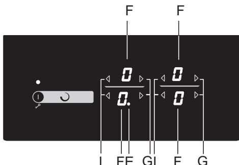
Pro vypnutí varné zóny použijte příslušné tlačítko "-" k nastavení hodnoty na "0".
