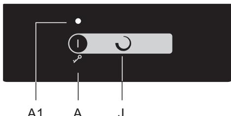
Dotkněte se tlačítka zapnutí/vypnutí (A) a podržte ho na 1 sekundu, čímž zapnete varnou desku. Na všech indikátorech úrovňě výkonu se zobrazí "0". Zazní krátký akustický signál a nad tlačítkem "on" se rozsvítí kontrolka.
