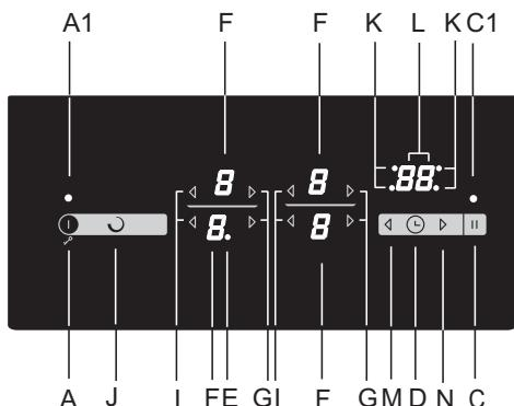
Varná zóna by měla být vypnutá (na displeji by měla být "0"). Stiskněte příslušné tlačítko "+" a podržte jej po dobu 3 vteřin, než uslyšíte krátké pípnutí. Na displeji začnou střídavě blikat "A" a "9". Snižte výkon na úroveň, na které budete vařit po automatickém rychlém ohřevu. "A" a zvolená úroveň ohřevu budou střídavě blikat na displeji. Po uplynutí automatického rychlého ohřevu se varná zóna automaticky přepne na požadovanou úroveň, která poté bude zobrazena.
