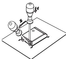
Převáděcí vodiče (propojky) jsou umístěny do určeného místa na svorce.
