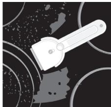
Odstraňujte těžko odstranitelné a spálené zbytky škrabkou. Při práci se škrabkou budete opatrní, abyste se nezranili.
