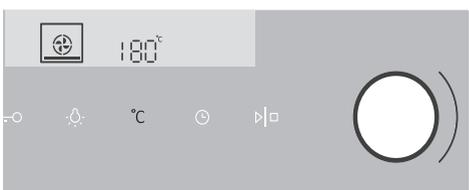
**2** Dotkněte se TLAČÍTKA TEPLOTA. Otáčejte KOLEČKEM NASTAVENÍ (-/+ ) a zvolte požadovanou **teplotu**.
