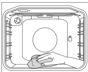
**1** Otočte OTOČNÝ VOLIČ REŽIMU PEČENÍ na Aqua Clean. 2. Nastavte VOLIČ TEPLoty na 70°C.
