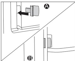
Při instalaci plně vysouvacích vodítek s katalytickými vložkami, vložte jeden konec dodané upínadel zámky do otvoru v dolní části vnitřku trouby a vložte druhý konec úchytné zámky do vodítek. Účelem upínadel zámků je držet vodítka pevně na místě.
