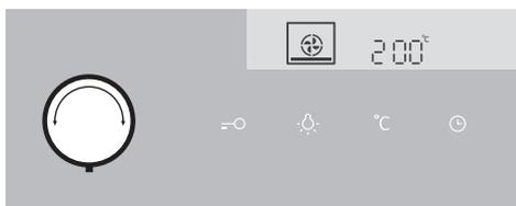
**1** Vyberte SYSTÉM VAŘENÍ. Vybraná ikona se objeví na displeji a bliká PŘEDEM NASTAVENÁ TEPLOTA.
