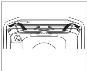
💡 Nikdy nepoužívejte topné těleso, když je uvolněné z držáků. Po vyčištění, dodržujte stejný postup v opačném pořadí, abyste zatlačili topné těleso zpět do držáků na své místo.
