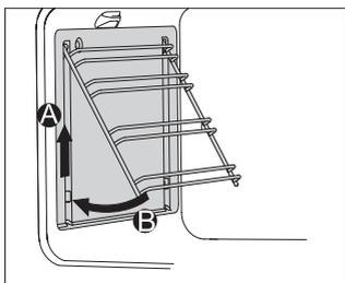
**2** Zavěste vložky s vodítky připojenými pomocí připravených otvorů a zatlačte směrem nahoru.
