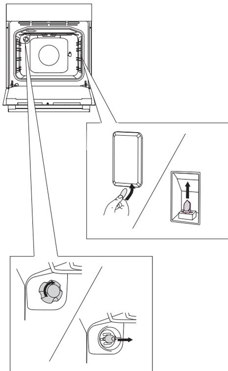
Pomocí plochého šroubováku uvolněte kryt žárovky a odstraňte ho. Vyjměte žárovku.
