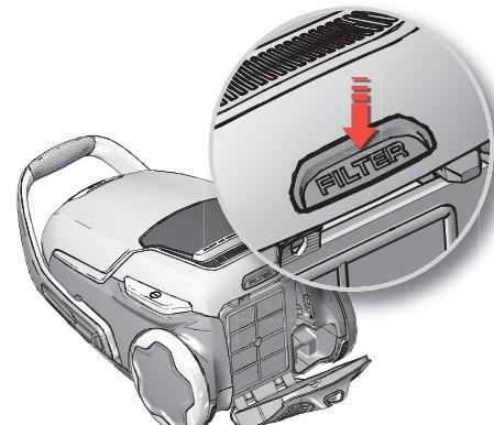
**3. Отворете капака на филтъра, като натиснете бутона ФИЛТЪР в задната част на уреда за почистване.** Използвайте оригинални филтри на Electrolux; EFS 1W / EFH 12W.
