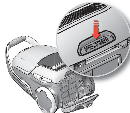
3. لفتح غطاء الفلتر قم بالضغط على زر **FILTER** أسفل المكنسة. يرجى استخدام فلاتر Electrolux الاصليّة: EFS 1W / EFH 12W.
