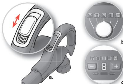
**9. Подесите јачину усисавања** **Модели ручном регулацијом:** а) Јачину усисавања можете брзо да подесите помоћу дугмата за регулацију јачине усисавања на ручки, б) Јачину усисавања можете да подесите помоћу ротирајућег дугмата на самом усисивачу, в) Јачину усисавања можете да подесите помоћу дугмади + и - на самом усисивачу.\*
