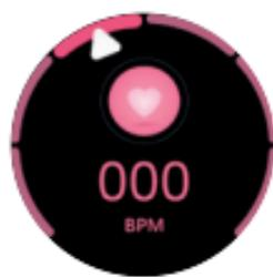
**bpm** Tepová frekvence – k měření se využívá snímač na zadní straně hodinek, je nutné, aby byly hodinky správně umístěny na zápěstí. Hodnota je orientační. Nelze použít pro zdravotní účely.
